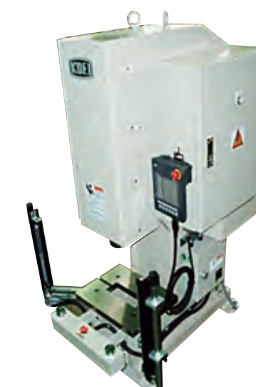
電動サーボプレス5TON KSV-5
