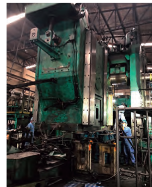
タイ現地法人での工事例 栗本鐵工所C2F-16 (1600t)
