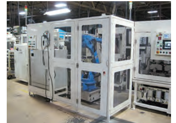
バランスシャフト ギヤ/ピン圧入機
