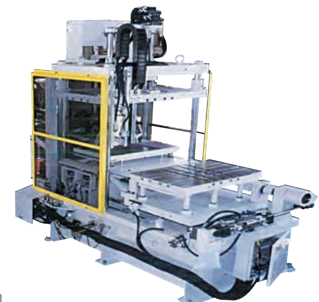
反転スライドテーブル付油圧トリミングプレス30TON
