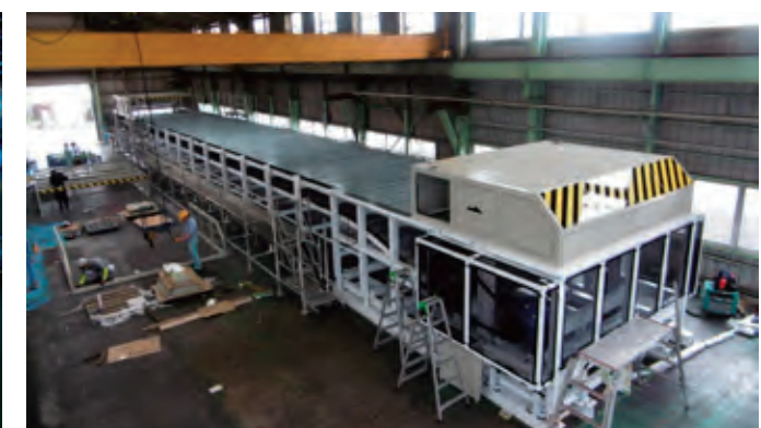
電動二輪車組立用スラットコンベヤ(スラット幅3500)
