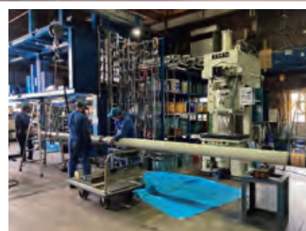
タイロッド折れ修理
