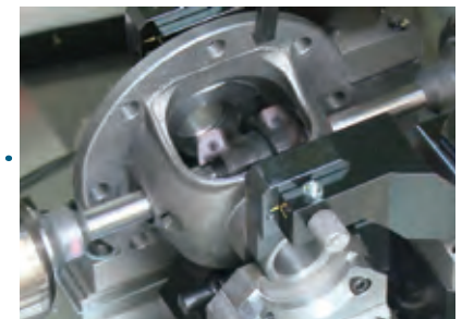
球面加工(左右) 球面と内面取りを加工
