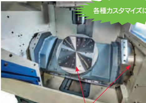
円テーブル駆動部に 防塵カバー設置
