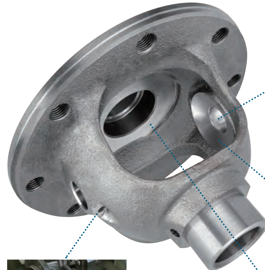
シャフト穴加工(左右) 下穴・中仕上・入口面取りの同時加工 高速リーマーにより超高速仕上げ加工
