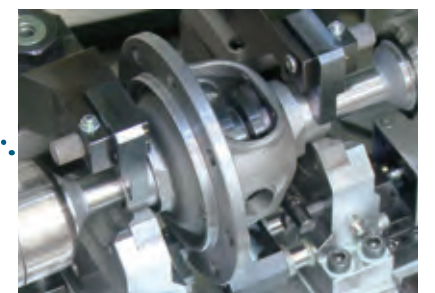
端面加工(左右) 総型カッターにより高速加工
