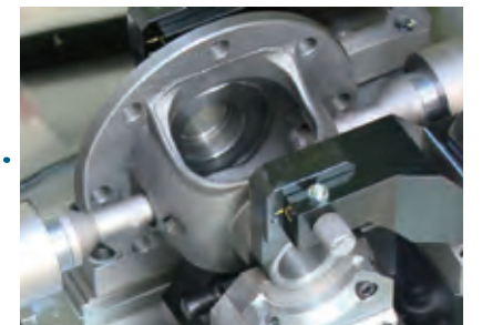
シャフト穴加工(左右) 下穴・中仕上・入口面取りの同時加工 高速リーマーにより超高速仕上げ加工
