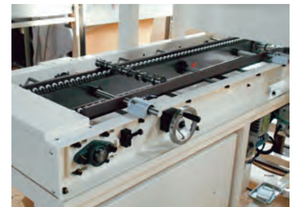
ローラー位置可変式 トップローラーコンベア
