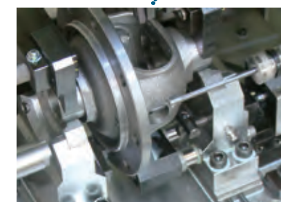
ノック穴加工 ミーリングによる半円面加工 エンドミルによる座繰り加工 ノック穴ドリル加工
