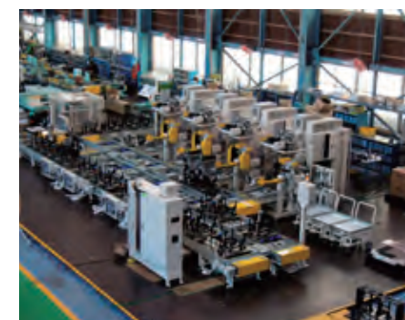
自動車エンジンモータリングテスト ベンチ周辺コンベヤ
