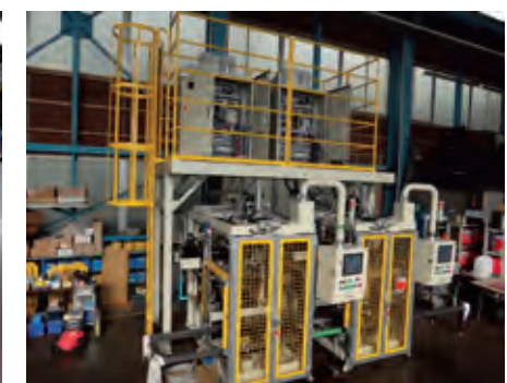
自動車用エンジンカム中心角測定装置
