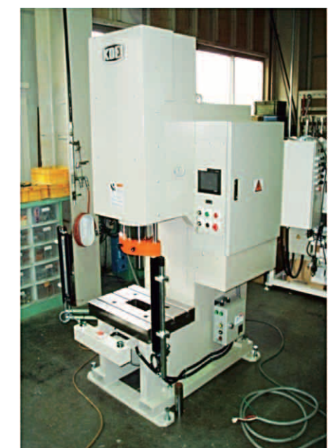
Hydraulic servo press 30 TON KUS-30
